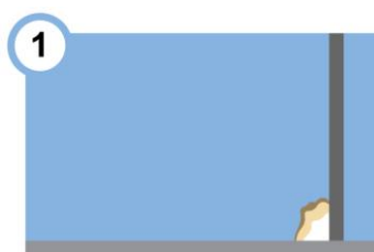
Daños en la esquina de los tableros de pared M-Bloc Ekcel Tipo X de 1/2"
