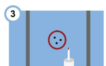
Aplique masilla de barrera contra fuego Fire Barrier Sealant CP 25WB+ de 3M al perímetro del parche de
